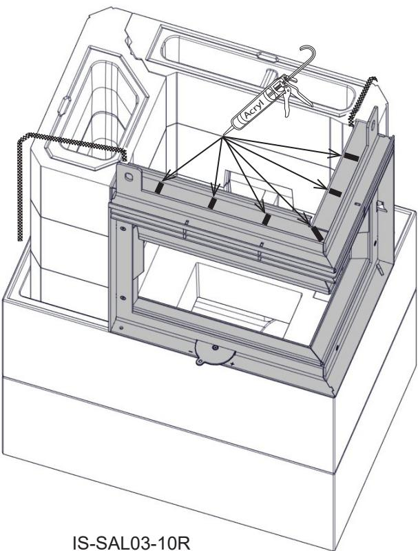
**DE** Positionieren Sie den Rahmen. Stellen Sie beim Einsetzen des Türrahmens sicher, dass die Dichtung an der vorgesehenen Position bleibt. Positionieren Sie die losen Dichtungsenden oben am Türrahmen. Tragen Sie Acryl zwischen den Dichtungen auf, bevor Sie ein neues Element platzieren.
