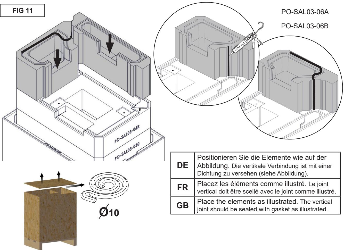
**DE** Positionieren Sie die Elemente wie auf der Abbildung. Die vertikale Verbindung ist mit einer Dichtung zu versehen (siehe Abbildung).
