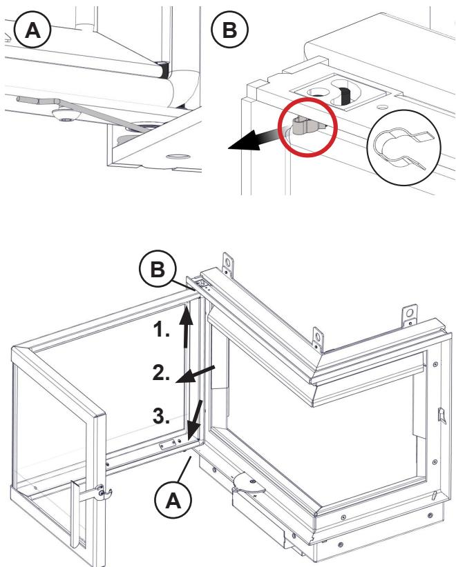
**DE** Wir empfehlen, die Tür während der Montage zu entfernen, damit sie nicht beschädigt wird. (A) Entnehmen Sie mit einer Zange das Ende der Feder, die hinter der Schraube an der Unterseite der Tür angebracht ist. (B) Entfernen Sie die Transportsicherung und heben Sie die Tür an (1) sowie von der Unterkante ab (2). Seien Sie vorsichtig, wenn die Tür vom Boden (3) abgehoben wird, damit der Rahmen nicht beschädigt wird
