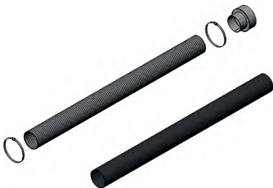
Paloilmaliitännä 80mm: adapteri Ø80x100mm putki Ø80mm, pit. 2000mm, joustava putki Ø80mm x 1000-3000mm IA-AIR00-020
